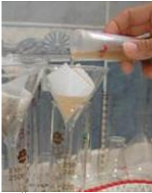
g. Örneklerin filtre kağıdından geçirilmesi ve SPE kartuşlarına boşaltılması Şekil 3.12. Örneklerin ekstraksiyonu
