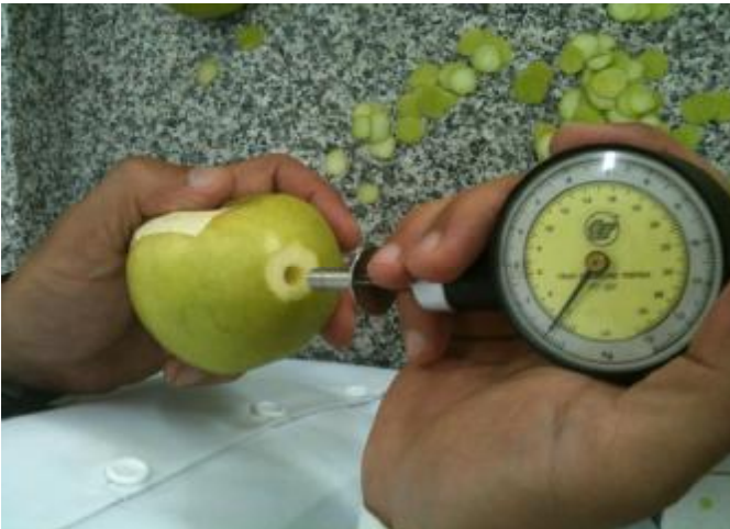
Şekil 3.2 Effegi marka penetrometre ile meyve eti sertliği ölçümü
