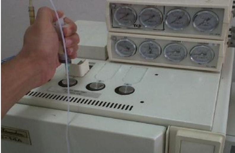
Şekil 3.4 Gaz kromotografında içsel etilen ölçümü
