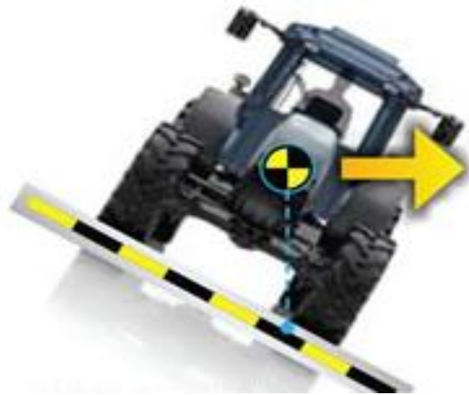
Şekil 2. Arazideki Eğimden Kaynaklanan Traktörün Devrilme Tehlikesi
