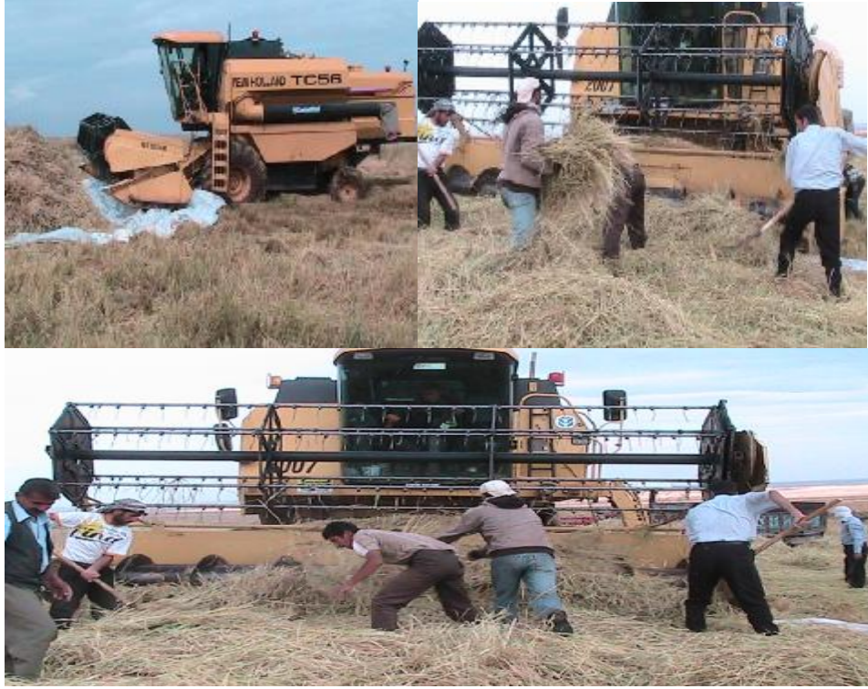
Şekil 3.19. Durağan biçerdöverde yapılan harmanlama ve besleme şekli
