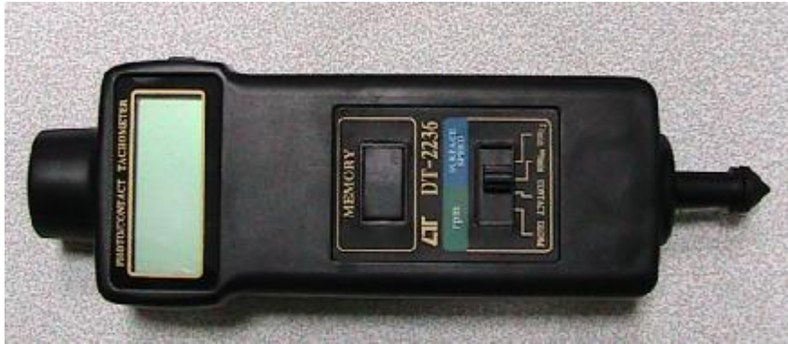
Şekil 3.7. Devir sayılarının ölçülmesinde kullanılan devir ölçer
