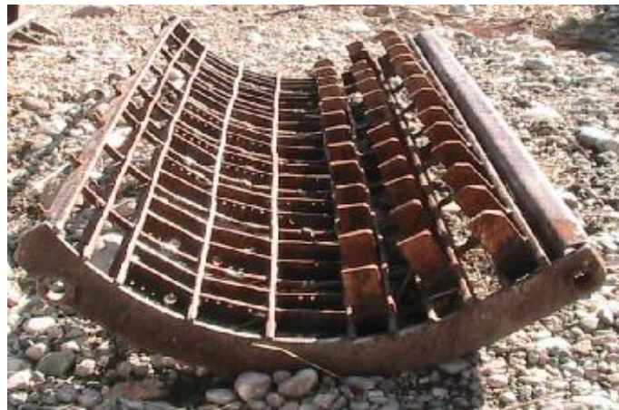
Şekil 3.5. Biçerdöverde kullanılan parmaklı tip kontrbatör
