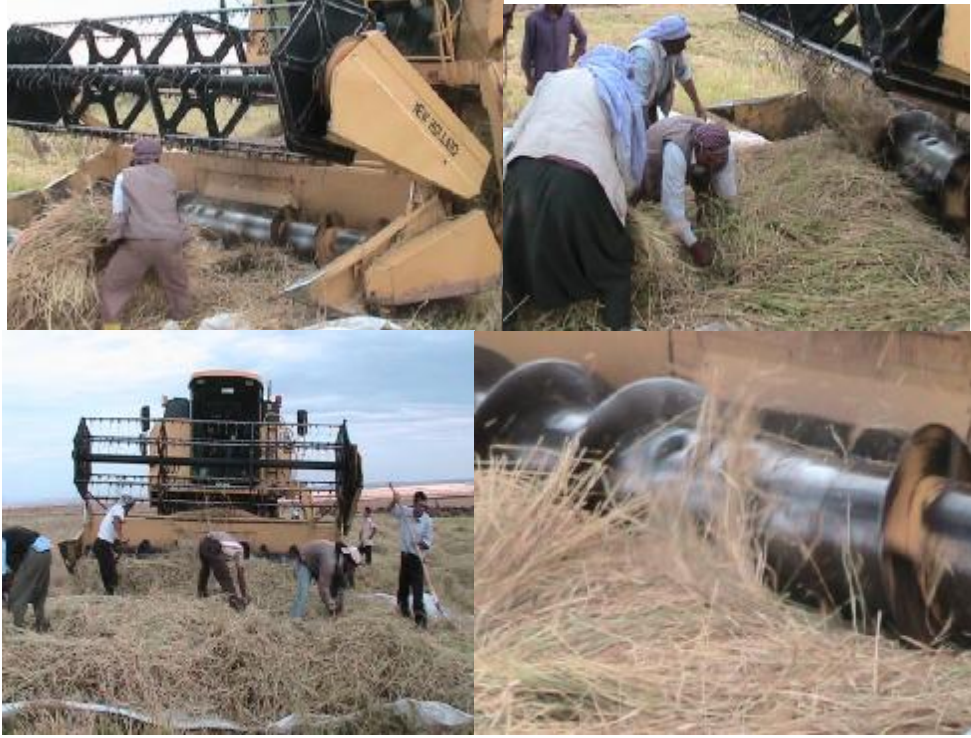
Şekil 1.11. Biçerdöverle yapılan harmanlama ve işçiler tarafından biçerdöver tablasına yedirilişi
