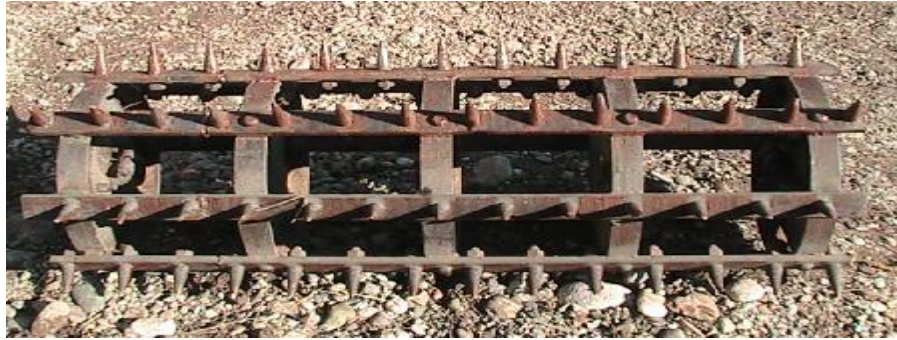
Şekil 3.4. Biçerdöverde kullanılan parmaklı tip batör (Balaban)
