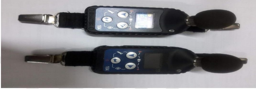
Şekil 3. 2. Gürültü ölçümü yapılan Svantek/SV104 marka ve modelli dozimetre
