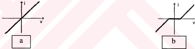
Şekil 3-2 a) Tersinir Elektrot Akım-Gerilim Grafiği b) Tersinmez Elektrot Akım-Gerilim Grafiği
