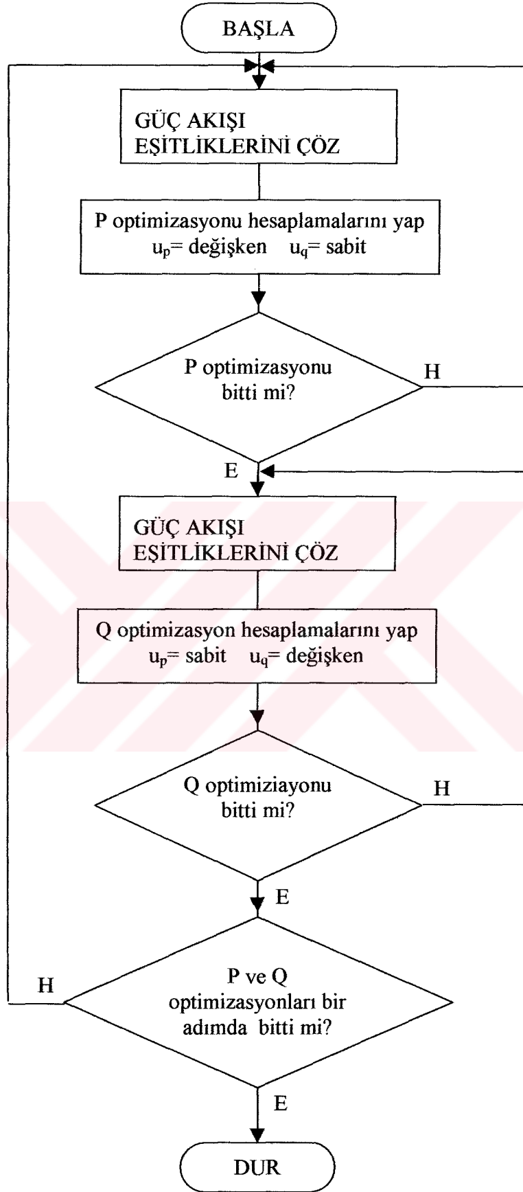
Şekil 2.3. P-Q optimizasyon algoritmasında kontrol değişkenleri
