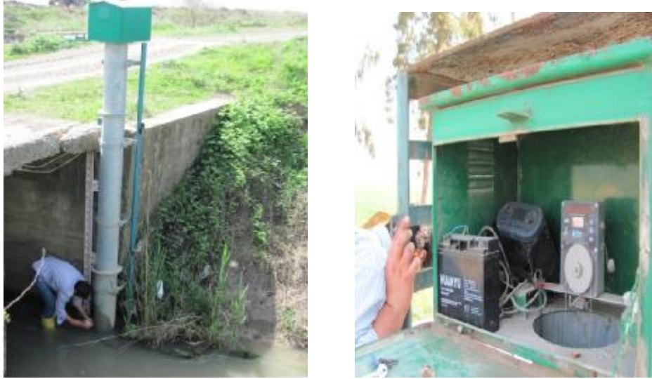
Şekil 3.9. Akarsu Sulama Birliği sulama sahasında akım gözlem istasyonlarında örnekleme çalışması ve limnigraf görüntüsü
