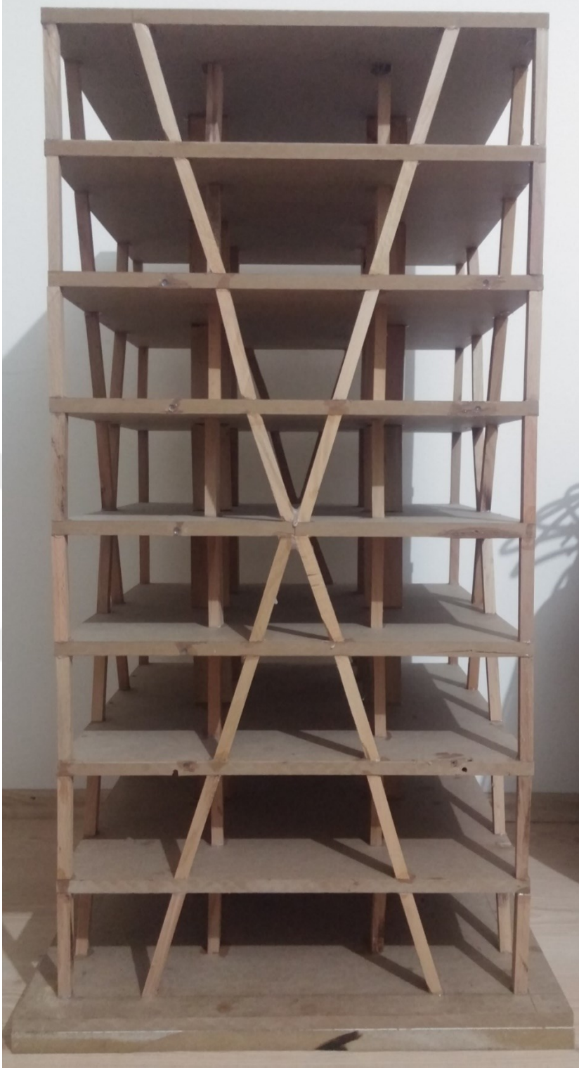
Şekil 2.8. Tamamlanmış eğik elemanlı model
