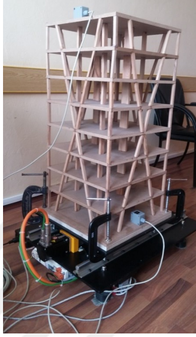
Şekil 2.12. Sarsma tablasına bağlanmış eğik kolonlu model
