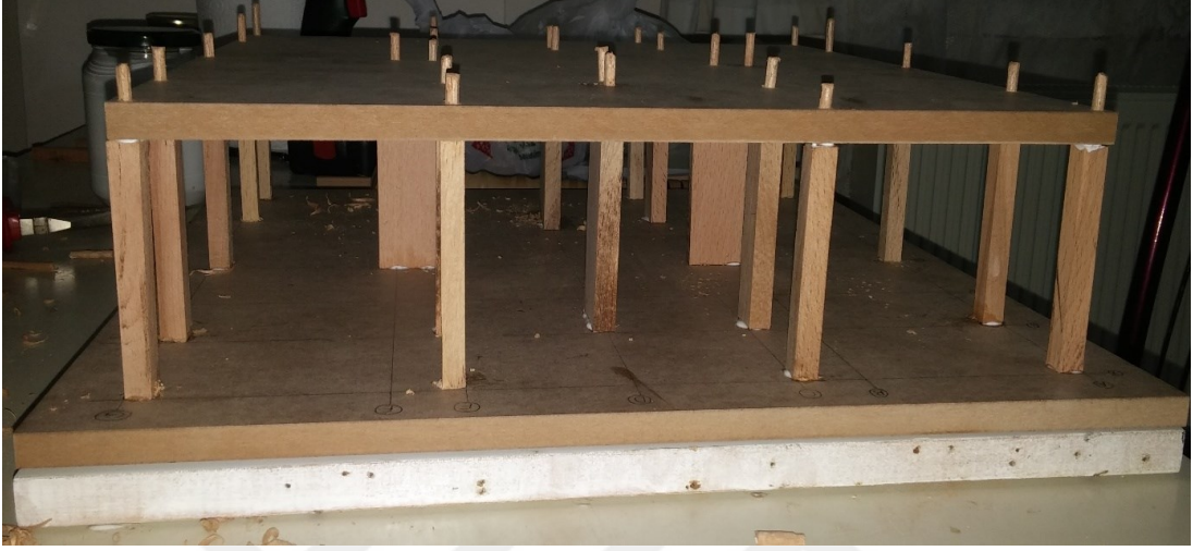
Şekil 2.6. Kurumaya bırakılan döşeme ve filizleri
