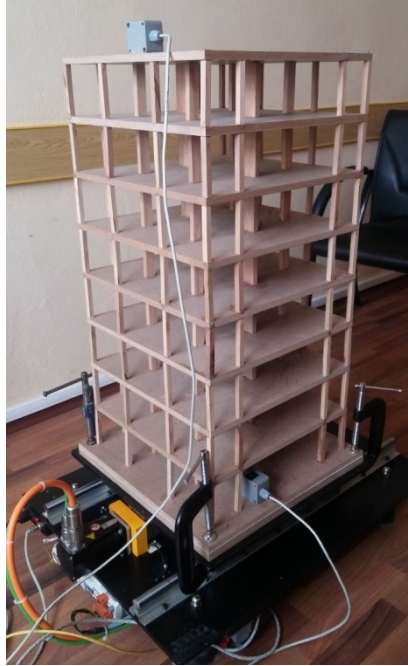
Şekil 2.13. Sarsma tablasına bağlanmış düz kolonlu model
