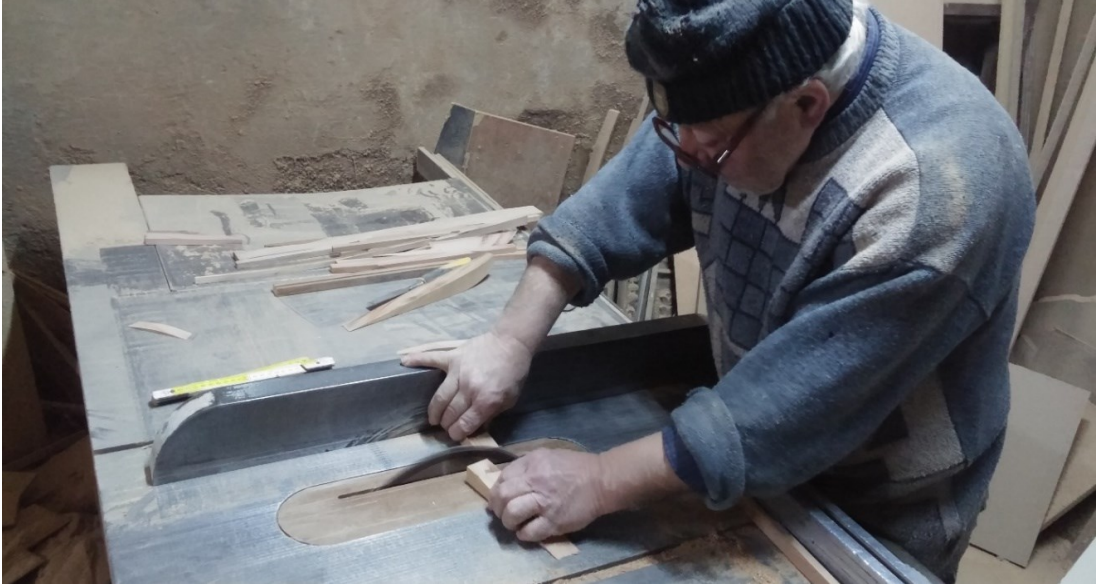
Şekil 2.1. Maket elemanlarının kesim aşaması
