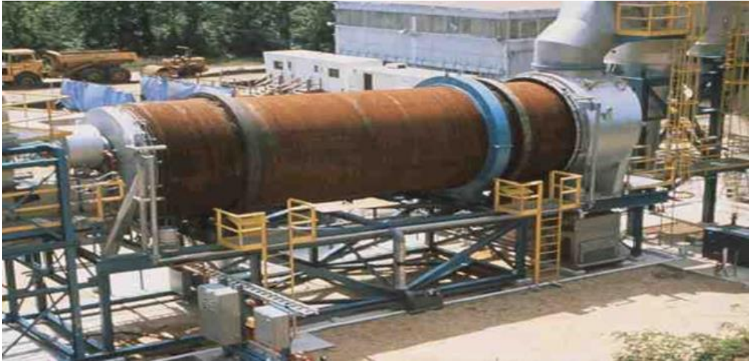
Şekil 4.13. Döner fırınlı yakma tesisi (Öztürk, 2010)
