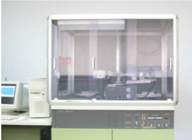
Şekil 3.3. Rigaku RadB-DMAX-II bilgisayar kontrollü X-ışını difraktometresi ( http://iys.inonu.edu.tr/index.php?web=ibtam&mw=2756&dil=tr ).
