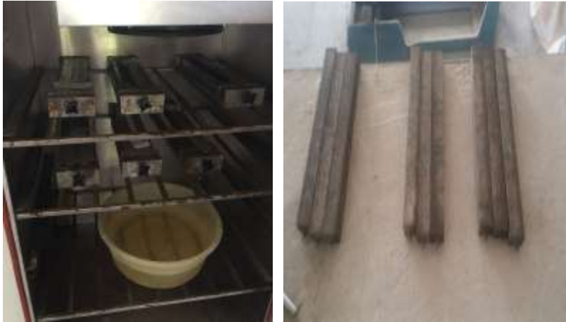
Şekil 2. Deneyde kullanılan harç çubuklarının kalıpları
