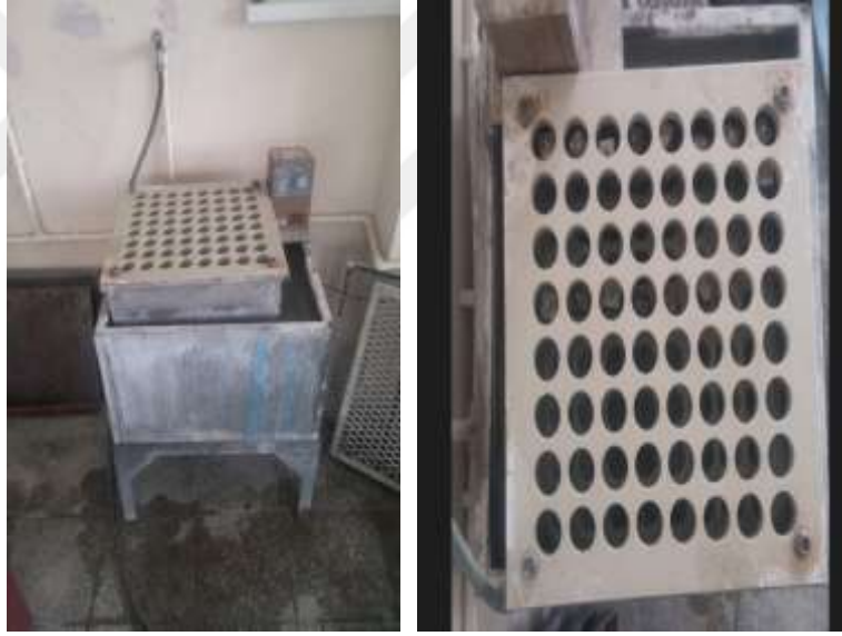
Şekil 4. Deneyde kullanılan alkali-silika tankı
