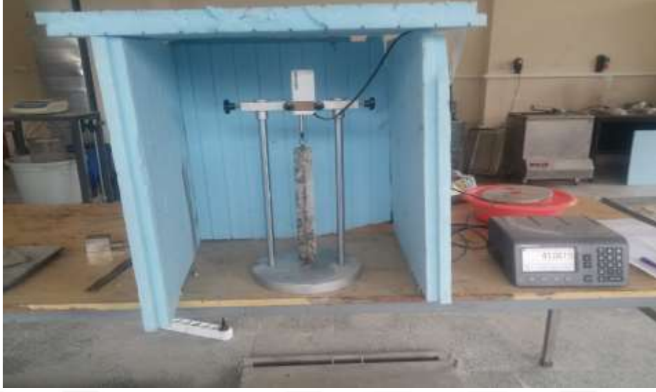
Şekil 3. Deneyde kullanılan boy ölçme cihazı
