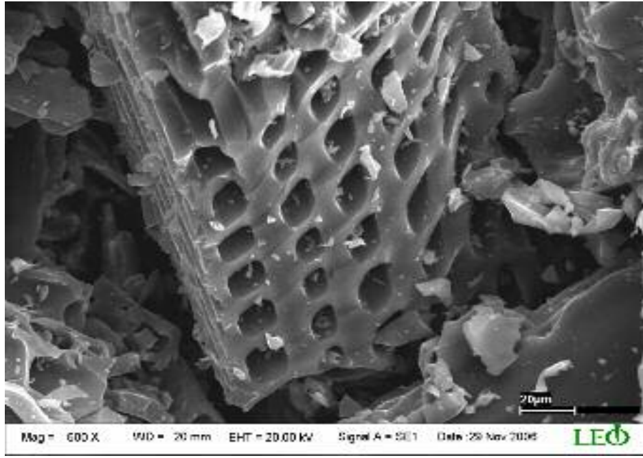
Şekil 4.15. (b) Aktif karbona ait SEM görüntüsü
