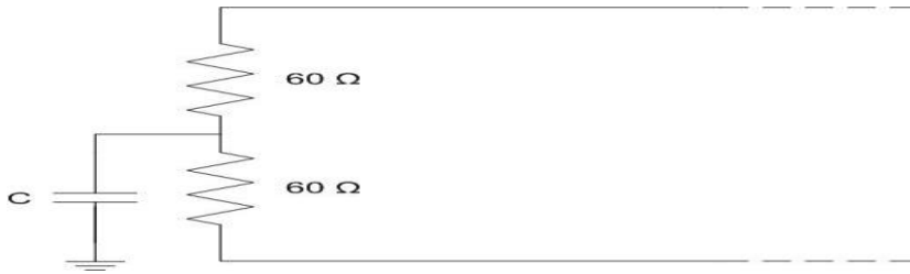
Şekil 3.6. Ayrılmış Sonlandırma (BOSCH CAN Specification [19]'dan değiştirilerek alınmıştır.)
