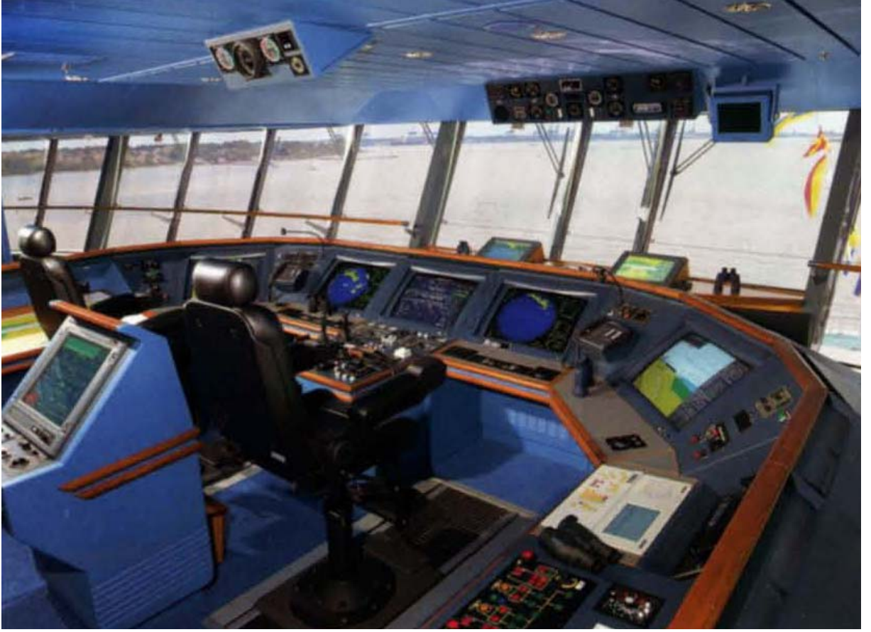
Şekil 18. Tümlüşik Köprüüstü Sistemi ile donatılmış bir geminin köprüüstü
