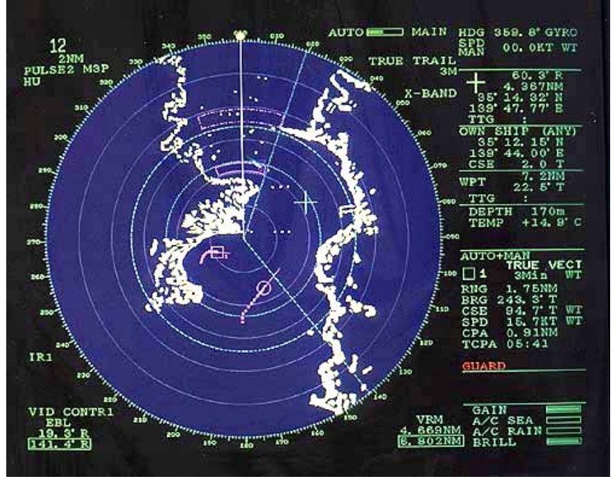
Şekil 9. ARPA Radar skop görüntüsü (Concord Marine Electronics http://www.concordelectronics.com/default.htm )
