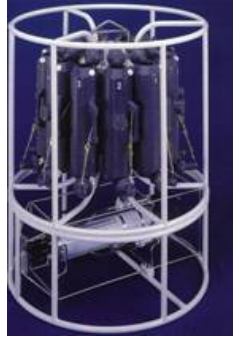
Şekil 7. Seyir Hidrografi ve Oşinografi Dairesi tarafından kullanılan Rosette örnekleycisi ve CTD cihazı*
