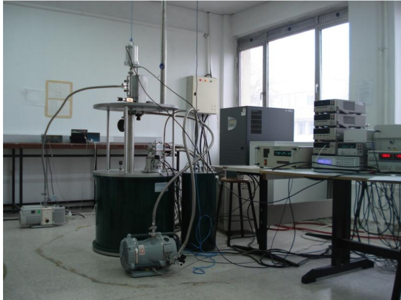
Şekil 3.27. Vibrating Sample Magnetometer (VSM) sisteminin şematik gösterimi [27].
