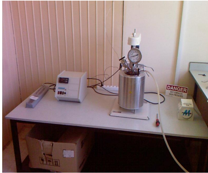
Şekil 3.25. Basınç sistemi ve reaktör kabı.
