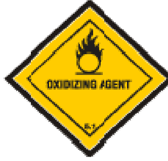
Şekil 8. IMDG koduna göre oksitleyici maddeler için kullanılan etiket.
