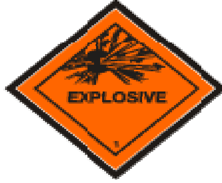
Şekil 1. IMDG koduna göre patlayıcılar için kullanılan etiket.
