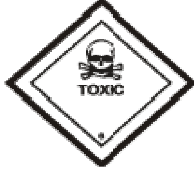
Şekil 10. IMDG koduna göre zehirleyici maddeler için kullanılan etiket.
