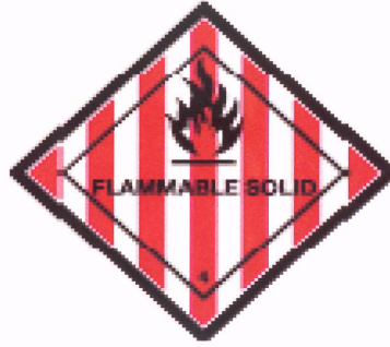
Şekil 5. IMDG koduna göre yanıcı katılar için kullanılan etiket.
