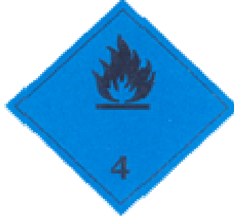
Şekil 7. IMDG koduna göre ıslandığında yanabilen katılar için kullanılan etiket.
