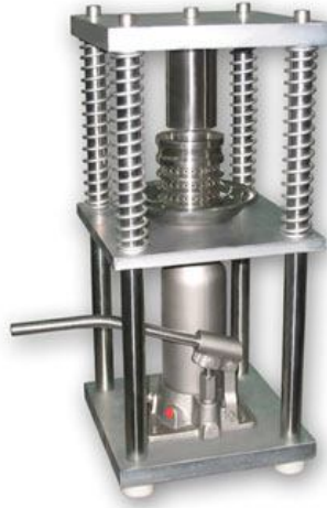
Şekil 3.6. Laboratuvar tipi pres
