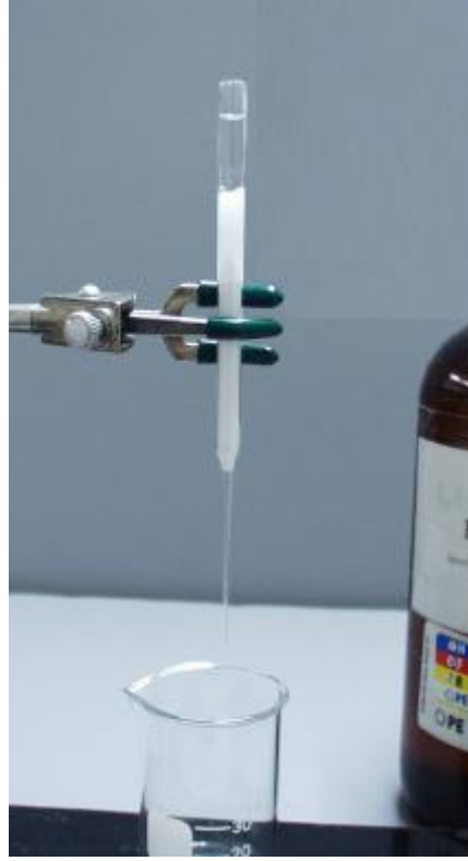
Şekil 13. Ekstraktı temizleme düzeneği
