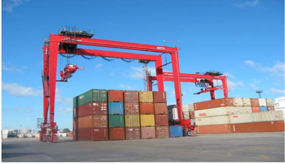
Şekil 8. Lastik tekerlekli gantry kreyn.
