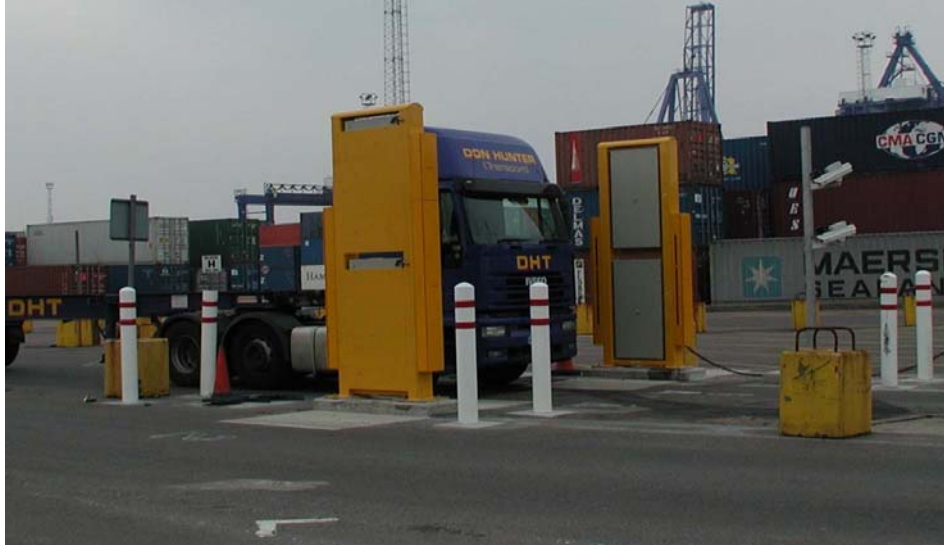
Şekil 15. Radyoaktif madde tespit sistemi.
