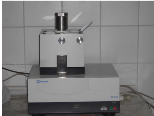
Foto 4. Çökel örneklerinin öğütüldüğü agat havan ve kurutulduğu fırın
