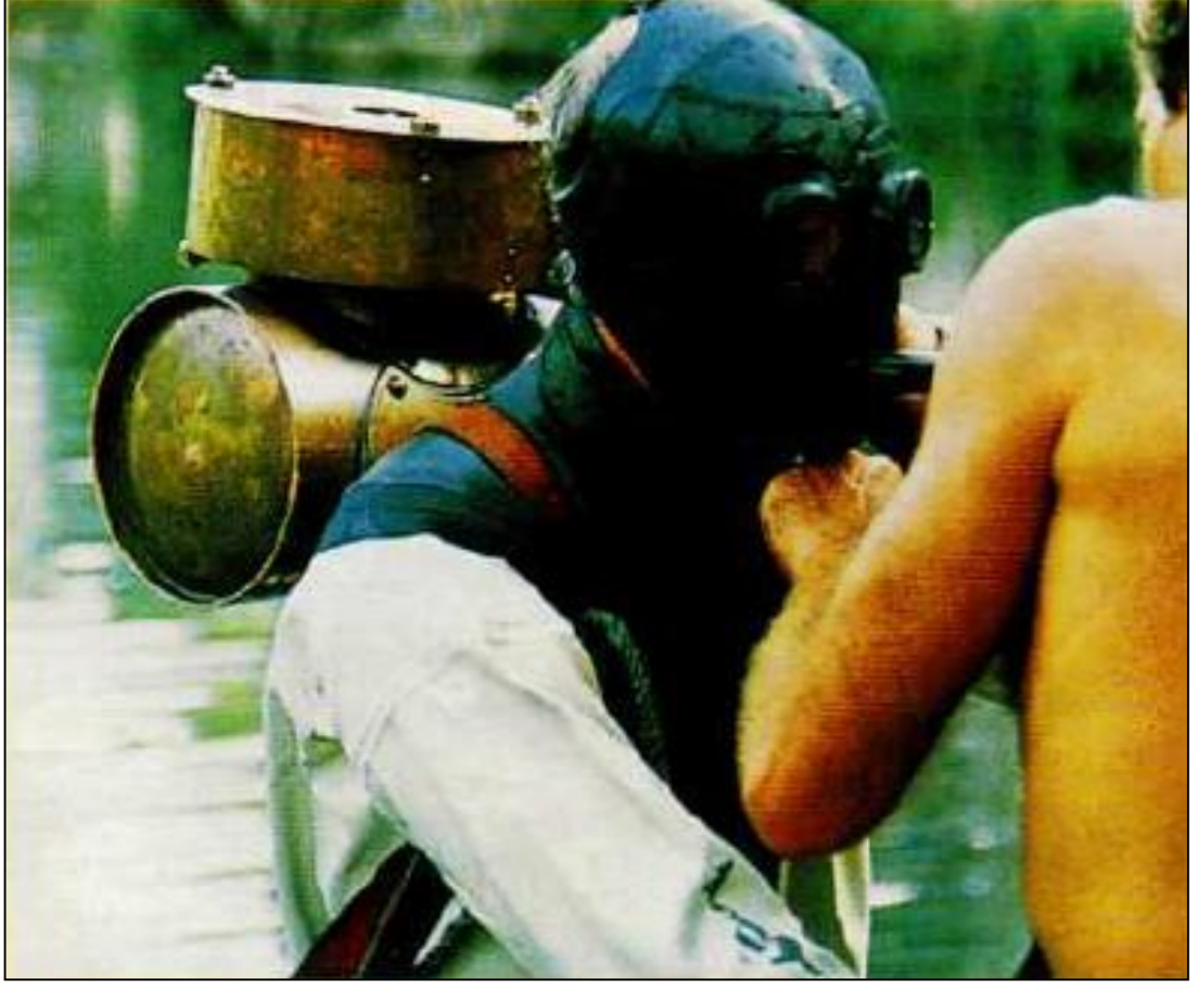
Şekil 16. Requayrol ve Denayrouze dalış elbisesi (Holland, 1999).
