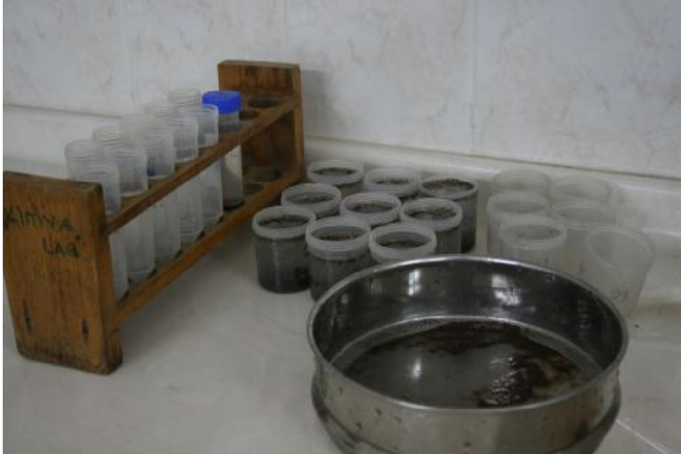
Şekil 3.2. Mikorizal fungusların topraktaki spor yoğunluklarının belirlenmesinde kullanılan ıslak elemenden bir görünüm
