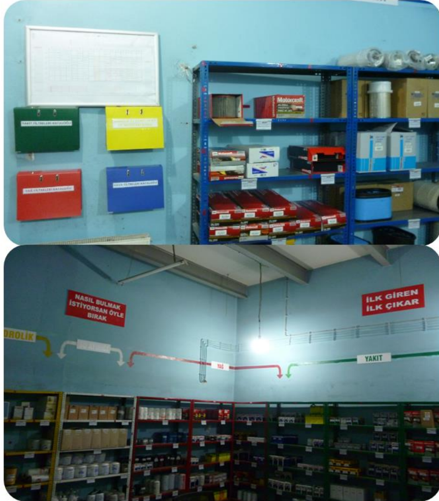
Şekil 4.9: Filtre deposunun 5S sonrası görünüm.
