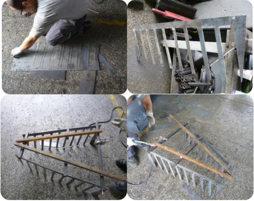
Şekil 4.23: Silecek standının yapım aşamaları.
