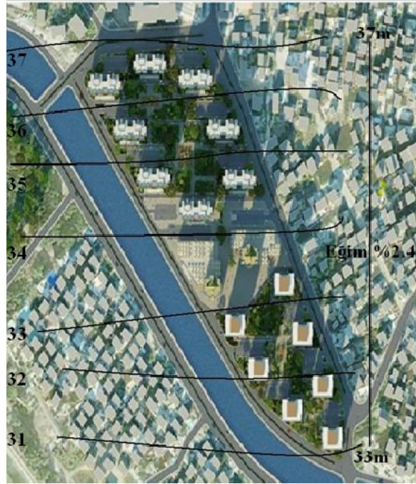
Şekil 4.2. Kışla Mahallesi kentsel dönüşüm proje alanı eğim durumu (Yüreğir Belediyesi).
