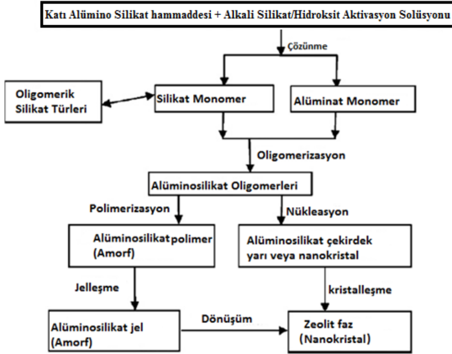
Şekil 5. Geopolimerizasyonun reaksiyon aşamaları
