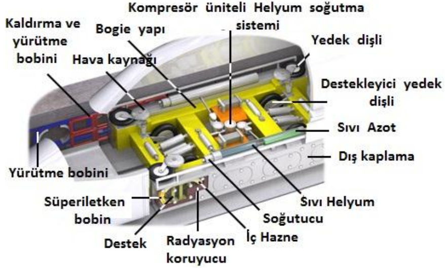
Şekil 2.12. Maglev taşıma sisteminin çalışma mekanizması [120] Bogie yapısı: demiryolu taşıtlarının kıvrımlı raylarda rahat ilerlemesini sağlayan sistem
