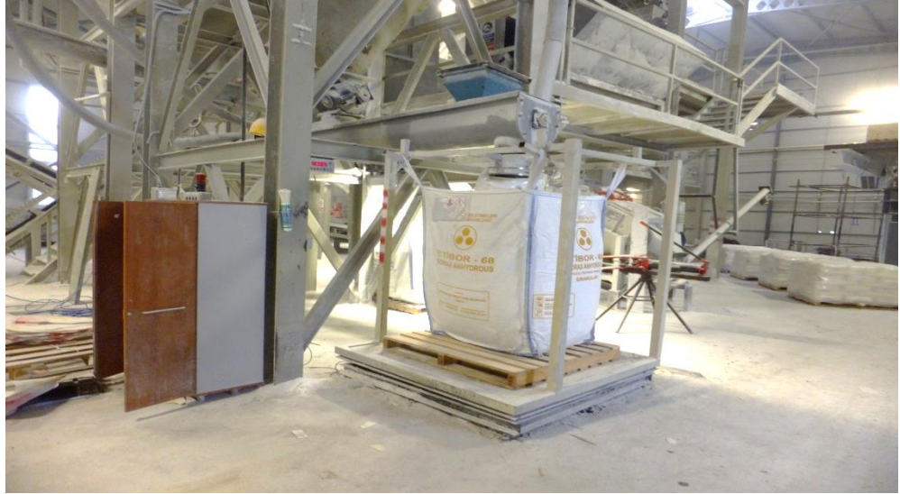
Şekil 3.2: Big bag dolum ünitesi ve dolum pozisyonu.
