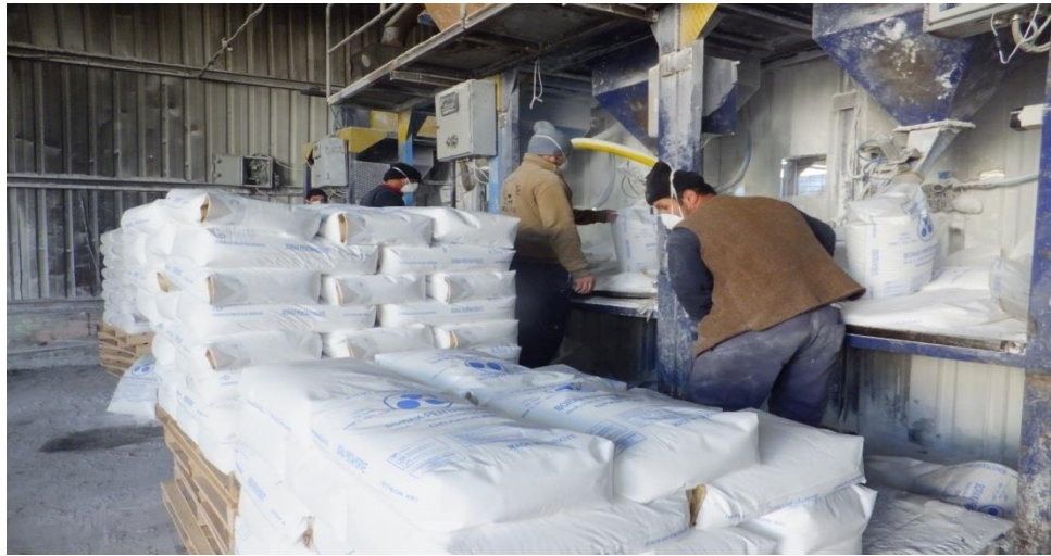
Şekil 3.3: 25-50 kg'lık torba dolum ünitesi ve dolum pozisyonu.
