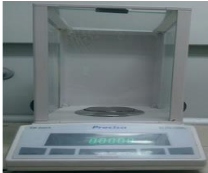
Şekil 3.12. Precisa XB 220 A model bir hassas terazi
