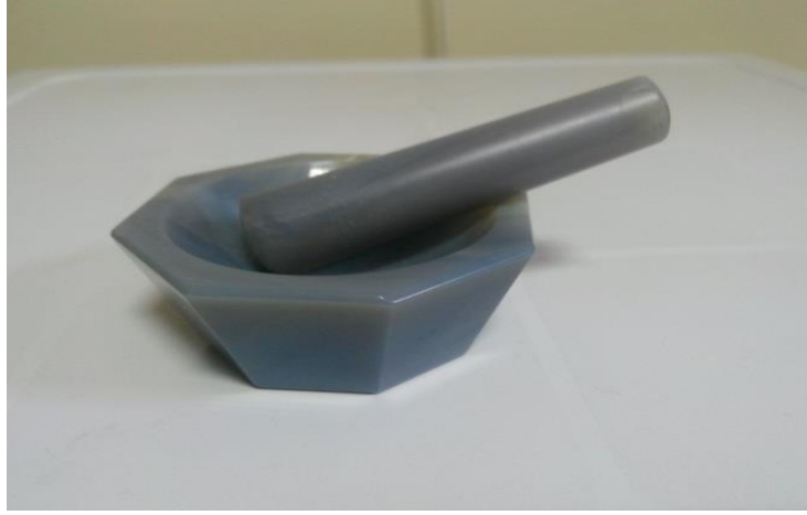
Şekil 3.11. Örnekleri öğütürken kullanılan agat havan
