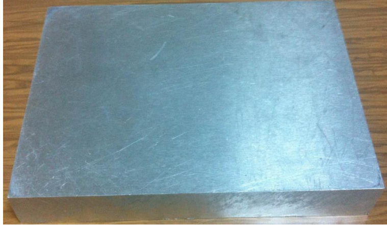
Şekil 3.16. Üretilen malzemelerin soğutulmasında kullanılan alüminyum metal blok
