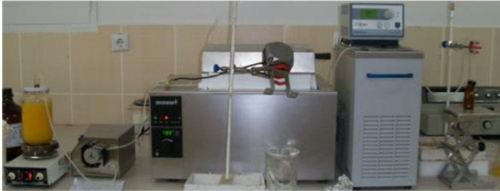
Şekil 3.5. Portakal suyunun ısı pastörizasyonu uygulamalarında kullanılan dükenek
