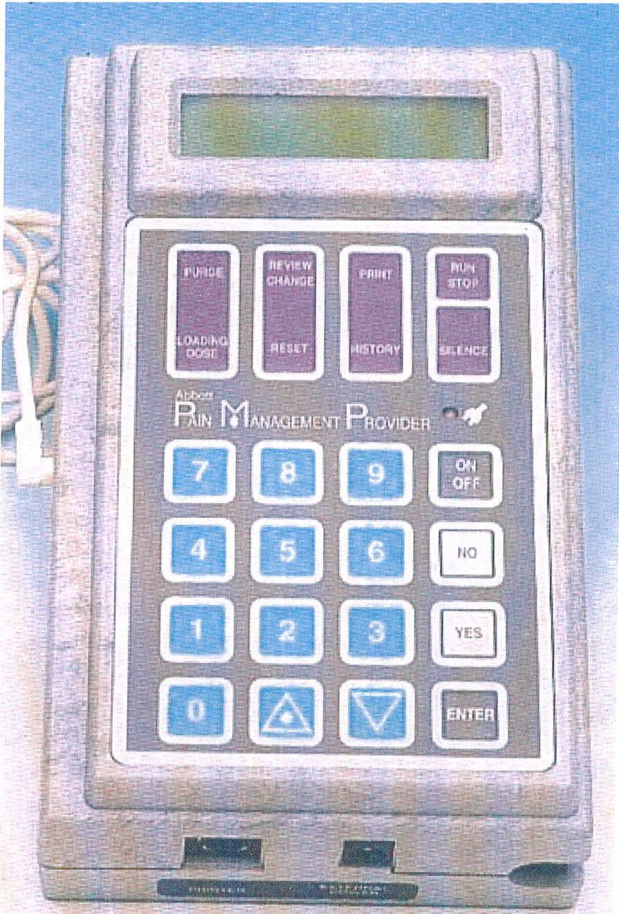
Şekil 8. Abbott® "Pain Management Provider" pompası
