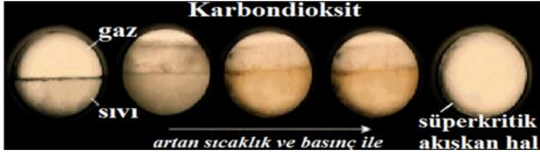
Şekil 1.4. Artan sıcaklık ve basınç ile CO 2 'in süperkritik akışkan hale geçişinin şematik gösterimi
