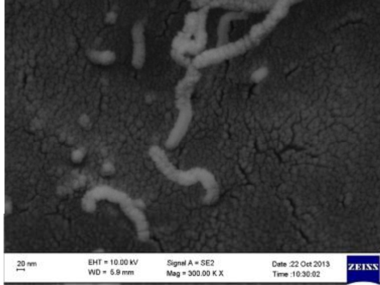
Şekil 4.31. MW-CNT üzerindeki Cu(hac) 2 'nin SEM görüntüsü
