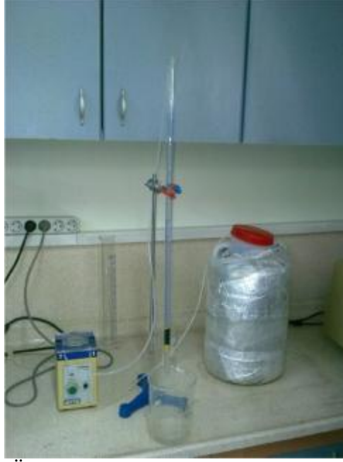
Şekil 3.5. Laboratuvar Ölçeğinde Sabit Yataklı Sürekli Akışlı GAK Adsorpsiyon Kolonu
