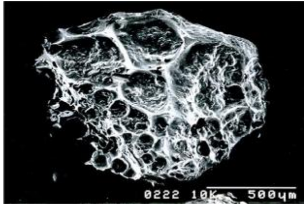
Şekil 1.5. Bir Aktif Karbon Granülünün Elektron Mikroskobunda Görünümü (500 μm) (Marshall ve Wartelle, 1999)
