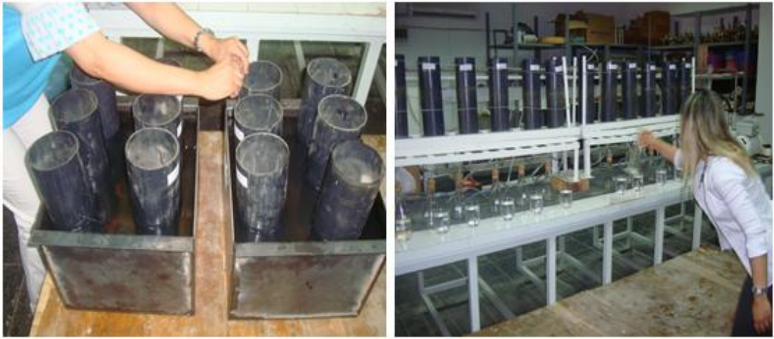
Şekil 3.5. Yıkama kolonlarının doygun hale getirilmesi ve yıkama düzeneğine alınması
