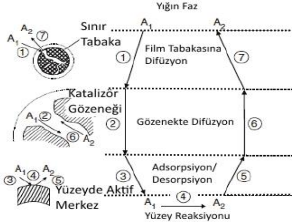
Şekil 2.2. Bir katalizör yüzeyine reaktanın kütle transferi ve reaksiyon basamakları (Fogler, 1992)
