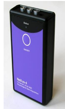
Şekil 3-1: Nexus 4 EEG-Biofeedback Ekranı ve Cihazı
