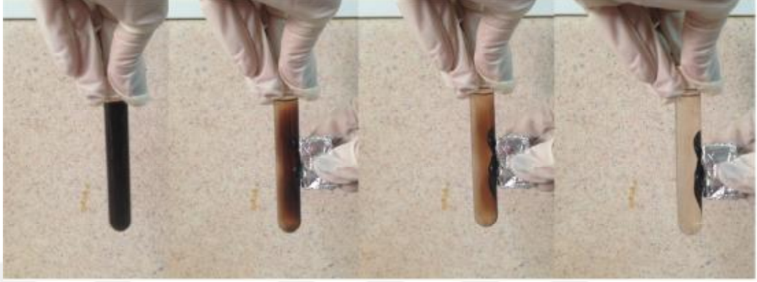
Şekil 3.1. Magnetitin Miknatis ile Ayrımı
