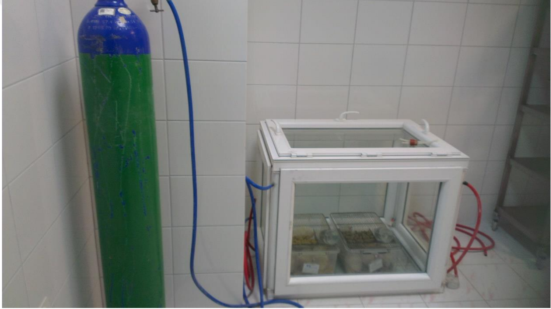
Şekil 3.2. Sıçanlar için hazırlanan düşük oksijen basıncı içeren düzenek ve kabin
