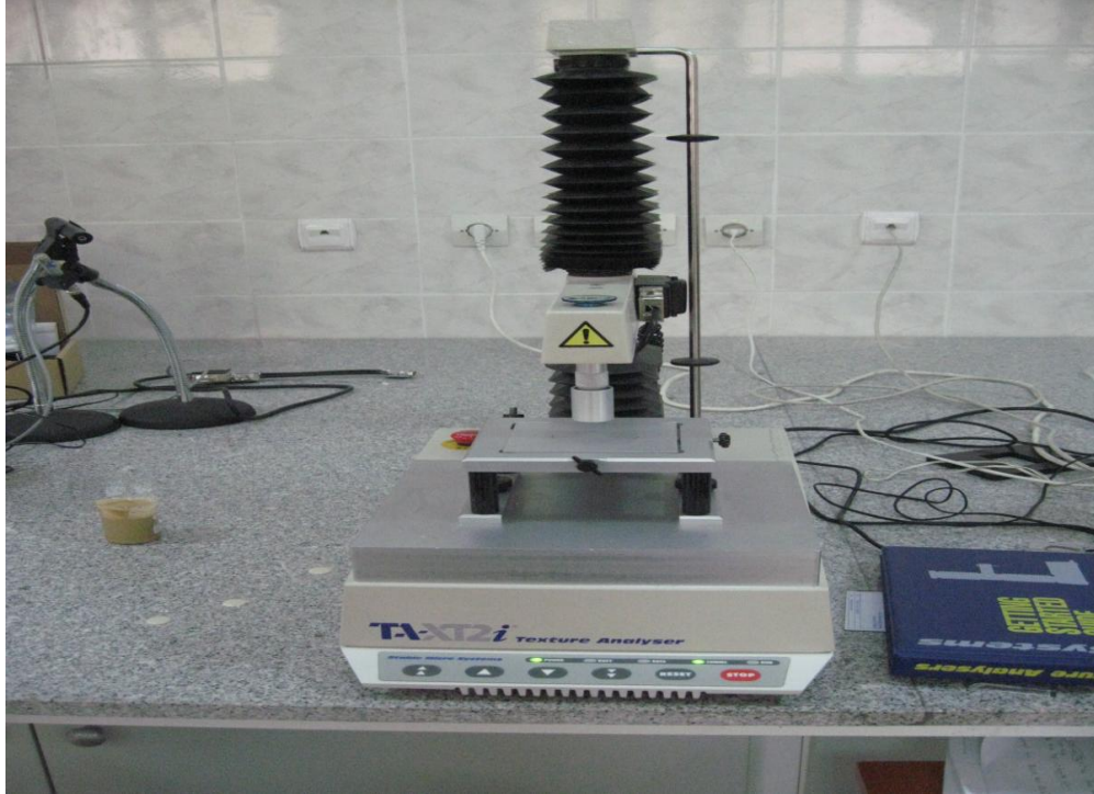
Resim 4: Biomekanik test yapılan cihaz (Texture Analyser)
