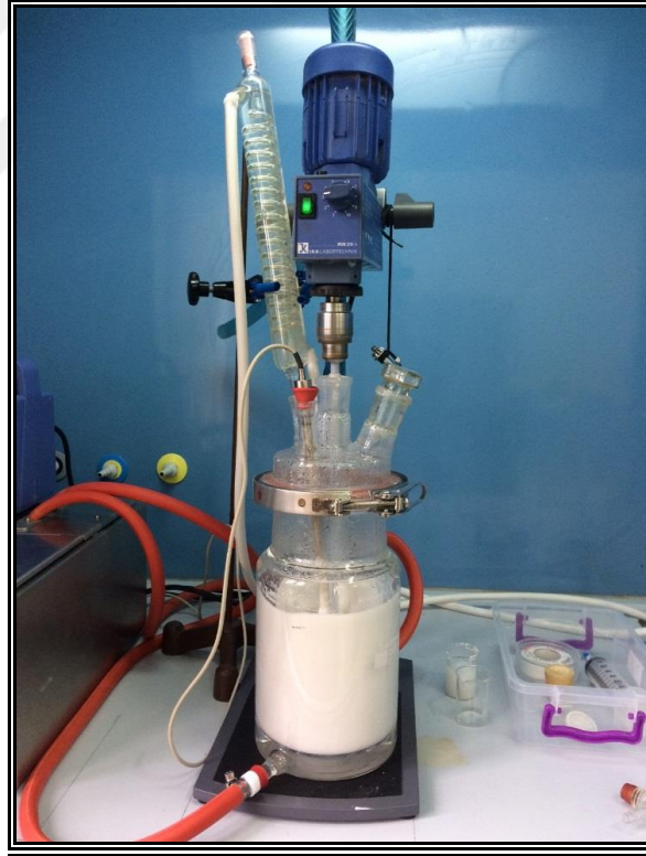
Şekil 3.7. Sürekli liç işlemi deney düzeneği
