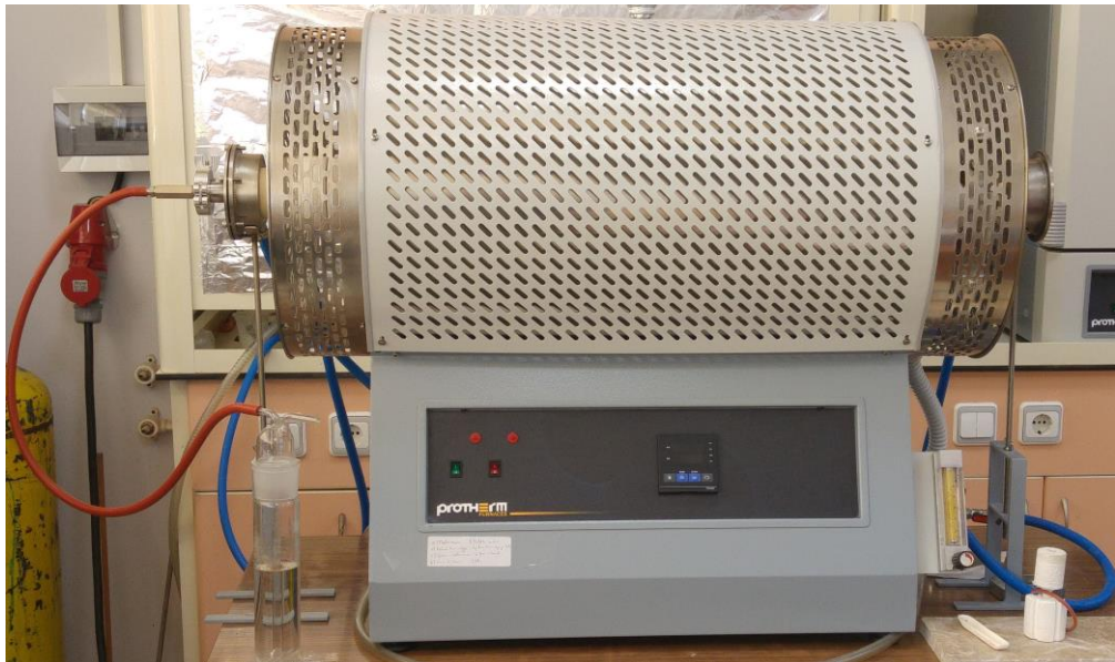
Şekil 3.10. Sinterleme çalışmalarında kullanılan su soğutmalı tüp fırın
