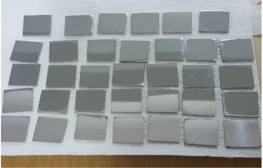
Şekil 3.2. Numunelerin yüzey temizleme işleminden önceki hali.
