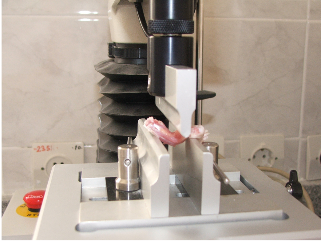
Resim 7. Cihazın kırma deneyi parçası
