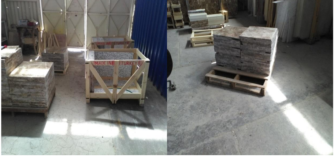
Şekil 3.14. Mermerlerin paletlenmesi ve ambajlanması
