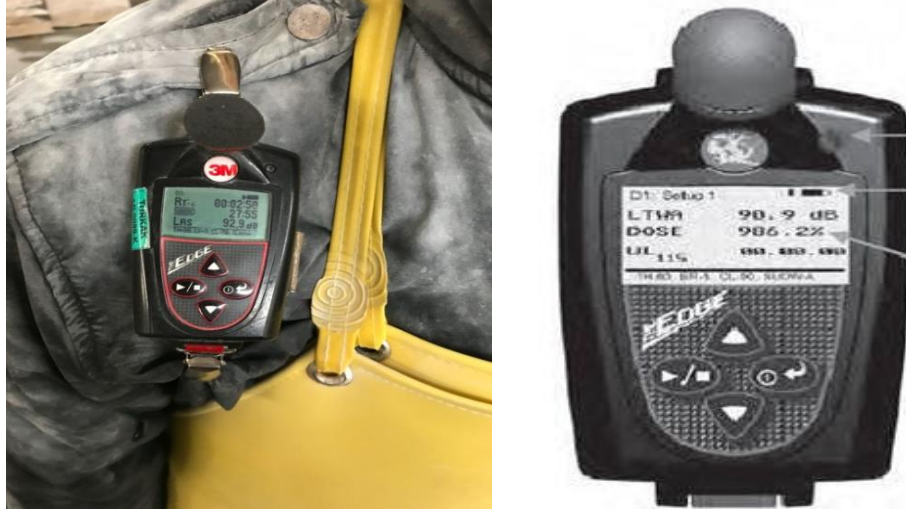
Şekil 3.19. Tesiste ölçüm yapılan gürültü cihazının görünümü
