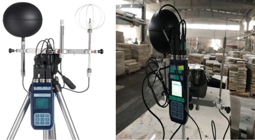
Şekil 3.18. Tesiste ölçüm yapılan termal konfor cihazının görünümü
