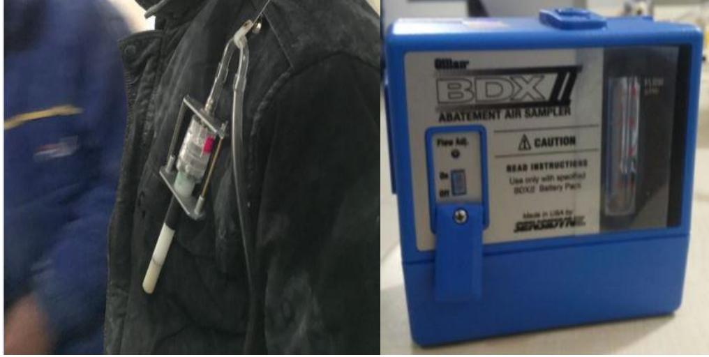
Şekil 3.20. Tesiste ölçüm yapılan toz cihazının görünümü
