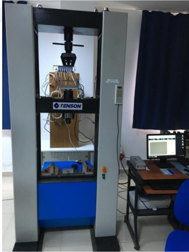
Resim 3.1: WDW-T50 model çekme test cihazı.
