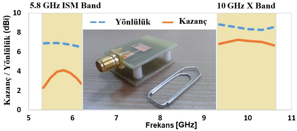
Şekil 4.10.11. 5.8 GHz ve 10 GHz band'ları için kazanç ve yönlülük eğrisi
