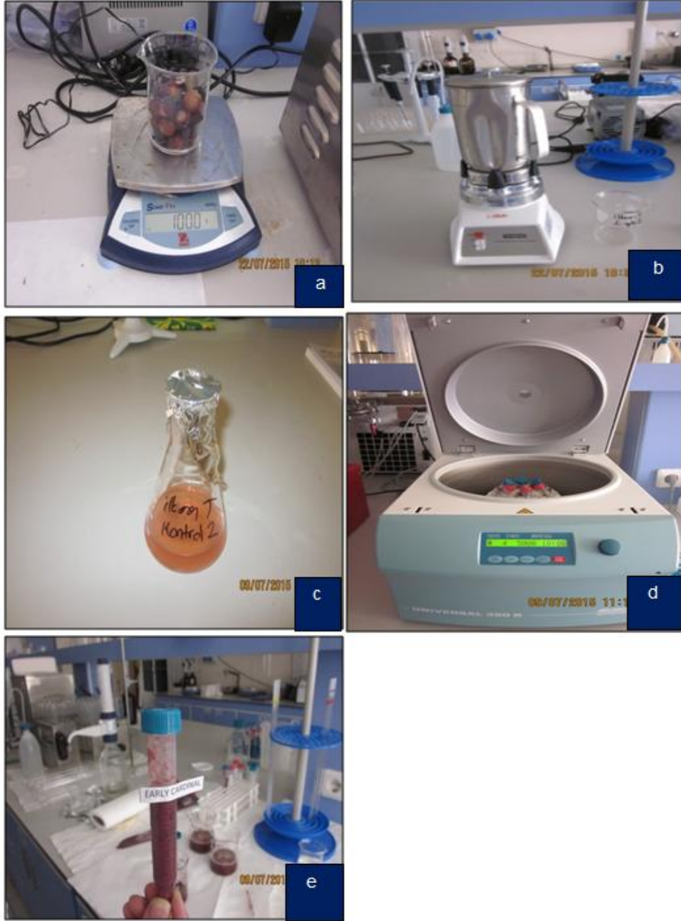
Şekil 3.10. Organik asit ve şeker örneklerinin analize hazırlanması (a- örneklerin tartımı, b- örneklerin parçalanması, c- seyreltilmiş örnek, d- santrifüjdeki örnek, e- santrifüjden çıkan örnek)
