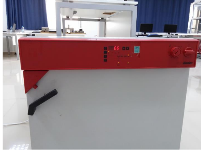
Şekil 6.14: Yapıştırıcının fırında kür edilmesi.
