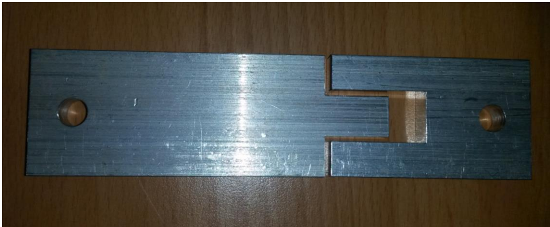
Şekil 5.6.b: Reçinelerde kayma testi uygulanacak yeni aparat.
