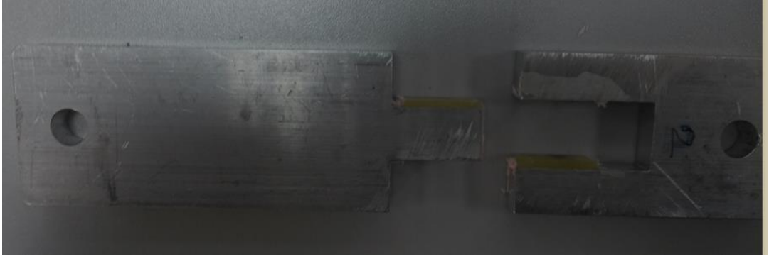
Şekil 6.8: Hysol yapısal yapıştırıcı test sonrası yapıştırıcı görünümü.
