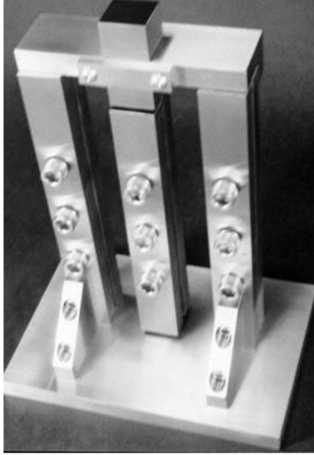
Şekil 4.7: ASTM D 4255 üç raylı kayma test numunesi [45].
