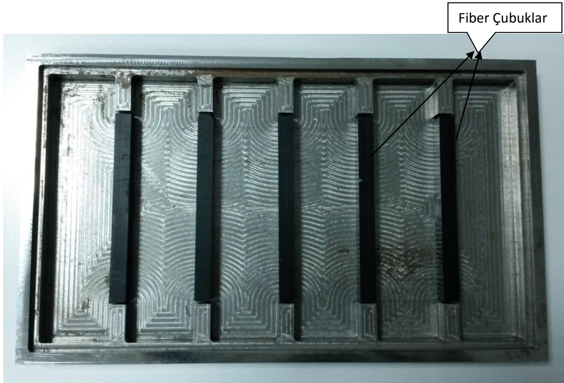
Şekil 5.9: Test aparatı kalıbı ve fiber çubuklar.
