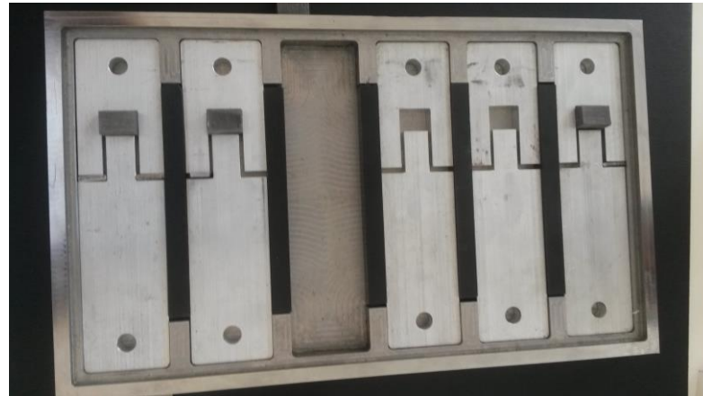
Şekil 5.15: Aparatların kalıba yerleştirilmesi.
