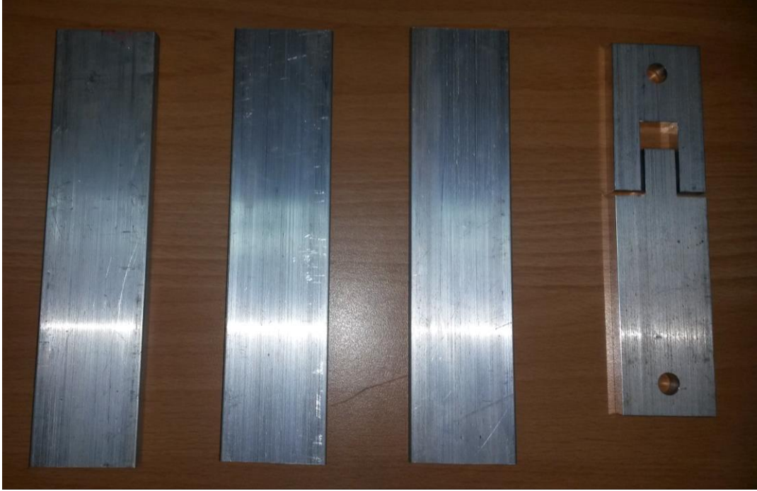
Şekil 5.6.a: Yeni aparatın işlenmemiş hali ve sağda işlenmiş hali.
