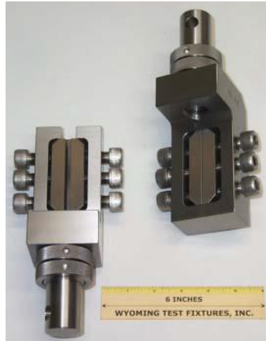
Şekil 5.5: V -Çentikli raylı test aparatı (ASTM D 7078)[45].
