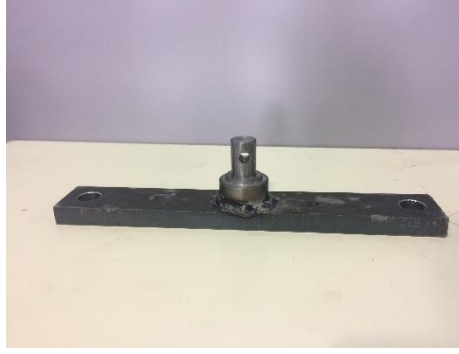
Şekil 4.43. Lineer motor için üretilen destek kolları
