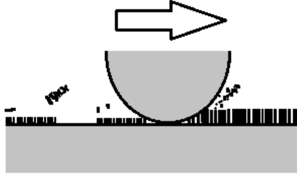
Şekil 3.10. Korozif aşınma oluşumu
