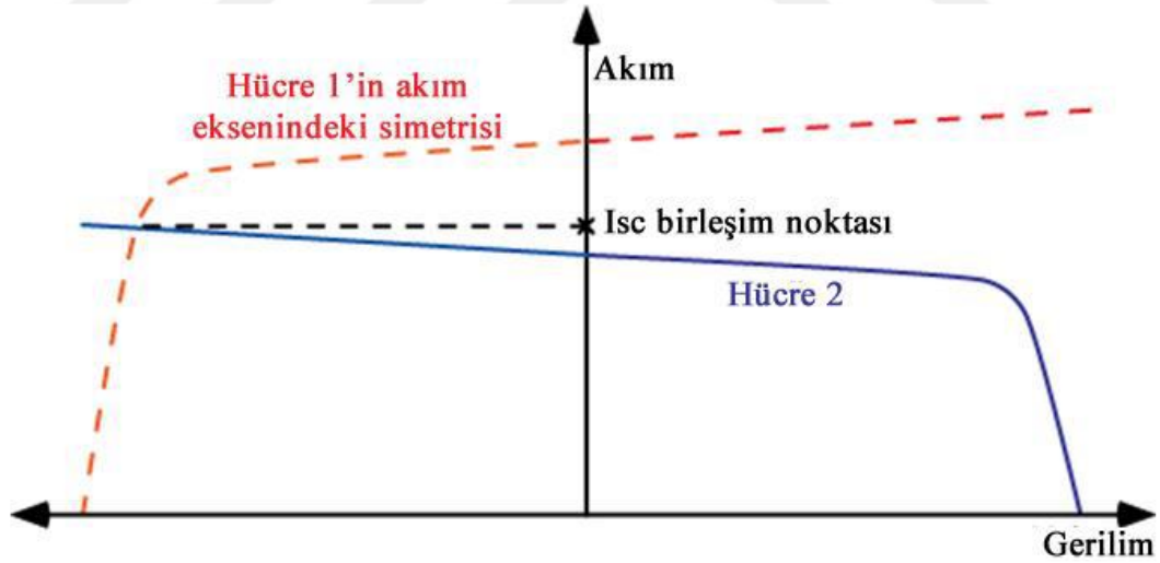
Şekil 3.5. Farklı PV panellerin seri bağlantıdaki akım eşdeğeri [124]
