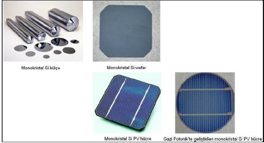
Şekil 2.10. Monokristal silisyum fotovoltaik hücre üretim aşamaları [64]
